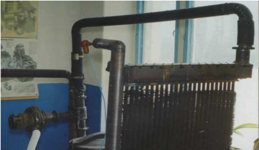
Додаток К Установка для роботи двигуна СМД-66 на деревному генераторному газу
