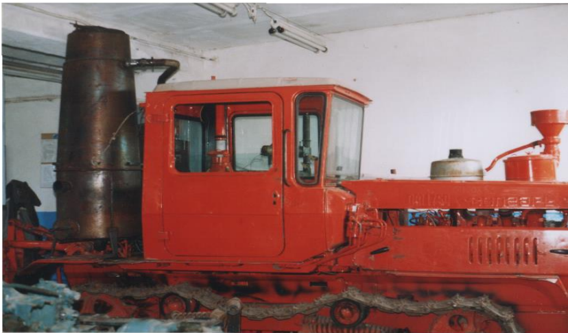
Додаток К Установка для роботи двигуна СМД-66 на деревному генераторному газу
